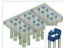
金型圧力センサー： ショートショットの検知
