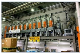
材料集中システム： 材料供給作業の省力化、誤材料使用の防止
